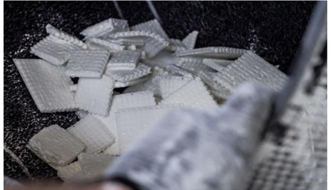
In ersten Experimenten mit Laser Sintering (SLS) waren die Schichten aus dem Druckprozess auf den Ohrringen sichtbar. Außerdem brachen die dünnwandigen Strukturen leicht und die Haptik der Bauteile entsprach nicht den Anforderungen von BOLTENSTERN an ein marktreifes Produkt.
