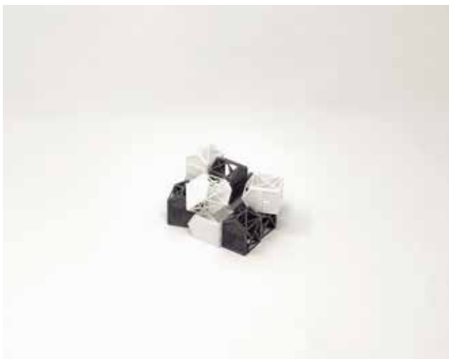
Abbildung 1: Vergleich manuell entpulverte und automatisiert entpulverte Bauteile in 10 Minuten
