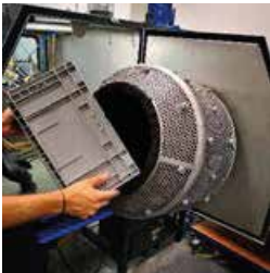
Abbildung 5: Prozess des automatisierten Entpulverns mit der DyeMansion Powershot C
