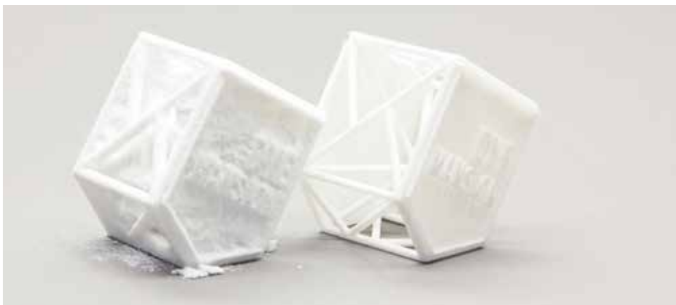
Abbildung 4: Bauteil vor und nach dem automatisierten Entpulvern mit der DyeMansion Powershot C
