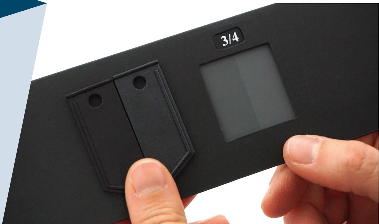
Abbildung 18: Visueller Vergleich eines Musterteils (vor und nach dem Test) anhand des Graumaßstabs
