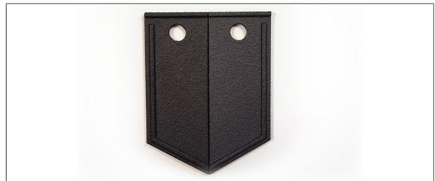
Abbildung 23: DM Black 01 auf HP 3D HR PA 12 (PSS) vor & nach der Lichtechtheitsprüfung
