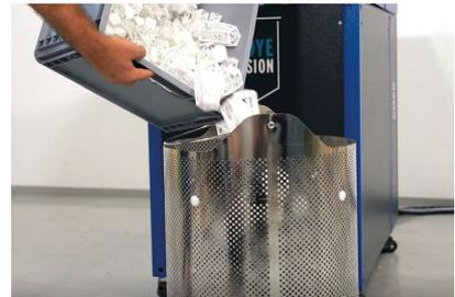
Abbildungen 6-8 V.L.N.R.: Der DeepDye Coloring (DDC) Prozess: Einlesen der Kartusche, Einlegen in den Korb, Befüllung des Korbes mit Bauteilen
