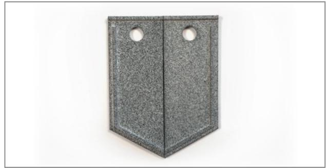
Abbildung 15: Ungefinishtes HP 3D HR PA 12 Musterteil
