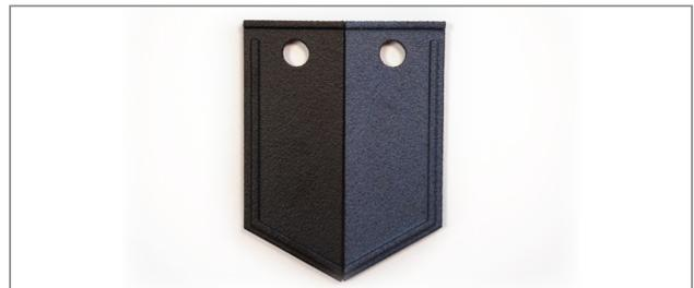
Abbildung 24: Textilfarbstoff HP 3D HR PA 12 (PSS) vor & nach der Lichtechtheitsprüfung
