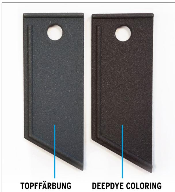
Abbildung 16: EOS PA 2200 Muster, gefärbt mit Textilfarbstoff (links) und mit DM Black 01 (rechts) - Parameter: s. Tabelle 2
